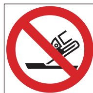
Ref. 434 Prohibido cortar de cara
