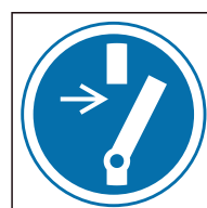
Ref. 259 Desconectar antes de reparación
