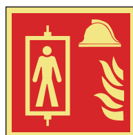
Ref. 17 Ascensor servicios de emergencia
