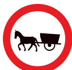
Ref. R-113 Prohibido a vehículos de tracción animal
