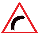
Ref. P-13A Curva peligrosa hacia la derecha
