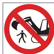
Ref. 473 Prohibido entrar en el radio de acción de la excavadora
