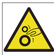
Ref. 358 Peligro Riesgo de atrapamiento
