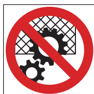
Ref. 477 Prohibido manipular el dispositivo de seguridad
