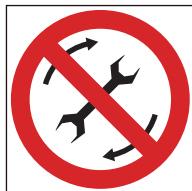
Ref. 482 Prohibido reparar la máquina en funcionamiento
