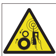
Ref. 308 Peligro Maquinaria accionada a distancia
