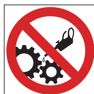
Ref. 472 Prohibido engrasar máquinas en funcionamiento
