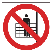
Ref. 470 Prohibido montacargas a personas
