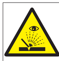
Ref. 371 Peligro Radiaciones ultravioleta
