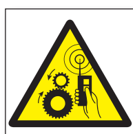
Ref. 308 Peligro maquinaria accionada a distancia
