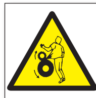
Ref. 377 Peligro Riesgo de atrapamiento
