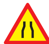
Ref. TP-17 Estrechamiento de calzada
