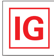
Ref. 2.25 Instalación de gas inerte
