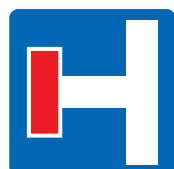
Ref. S-15-B Preseñalización de calzada sin salida
