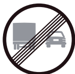
Ref. R-503 Fin de la prohibición de adelantamiento para camiones
