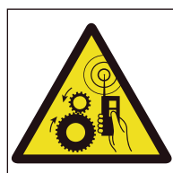
Ref. 308 Peligro maquinaria accionada a distancia
