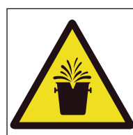
Ref. 372 Peligro Explosión material incandescente
