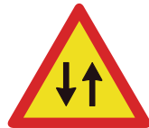
Ref. TP-25 Circulación en los dos sentidos
