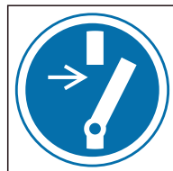
Ref. 259 Desconectar antes de reparación
