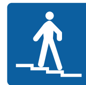
Ref. S-14-B Paso inferior para peatones
