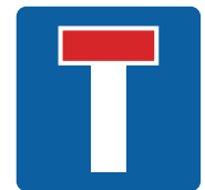
Ref. S-15-A Preseñalización de calzada sin salida
