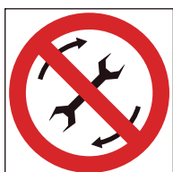
Ref. 482 Prohibido reparar la máquina en funcionamiento
