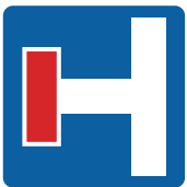
Ref. S-15-B Preseñalización de calzada sin salida
