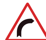
Ref. P-13-A Curva peligrosa hacia la derecha
