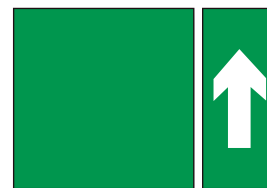
Ref. B-22 Indicador de dirección. Puede utilizarse con cualquier señal. La flecha debe estar orientada hacia el dispositivo o el puesto.
