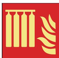
Ref. 38 Batería de equipos de extinción
